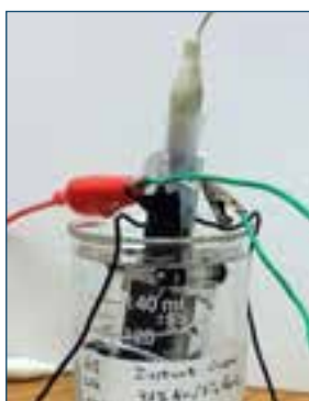
1. ábra: Sós vízben működtetett tartalékelem. Baloldalt: laborméretű modell (3 cm x 1 cm elektródok, egyszerű cella); Jobb oldalt: pilot méretű modell (250 cm x 250 cm elektródok, 5 párhuzamosan kapcsolt cella)
