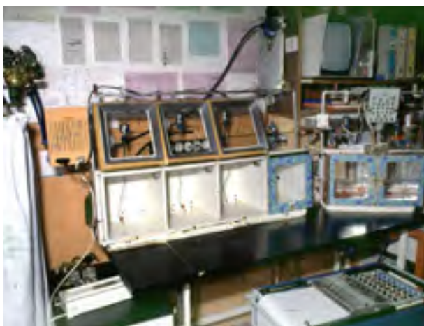
1. ábra: Hypoxiás kamrák. Balra látható a nitrogén palack, jobbra tőle az EEG szelektor kapcsoló. A kép jobb oldalán van 2 mérőkamra, felette az EEG csatlakozó doboza. Afölött 6 csatornás memória oszcilloszkóp található, alul jobbkézt a 8 csatornás EEG készülék. A kamrába fentről belógó EEG kábel az állat fején lévő csatlakozóhoz kapcsolódik. A kábel a kamra fölött levő kék forgó csatlakozóban végződik, ami lehetővé teszi a kísérleti állat forgását a kamrában, továbbá a sarokba is eljuthat. A két változó mérését két elektromos kapcsoló teszi lehetővé, amelyek vezetékei egy PC-hez csatlakoznak, valamint a PC-ben lévő, általunk épített kártya, ami a következő időmérést teszi lehetővé: az ajtó kinyitása a start; ez az iEEG idő - 1. számú változó, a vége pedig az, amikor az állat magához tér, vagy a bajuszának érintésére reagál; ez a visszatérési idő - 2. számú változó.
